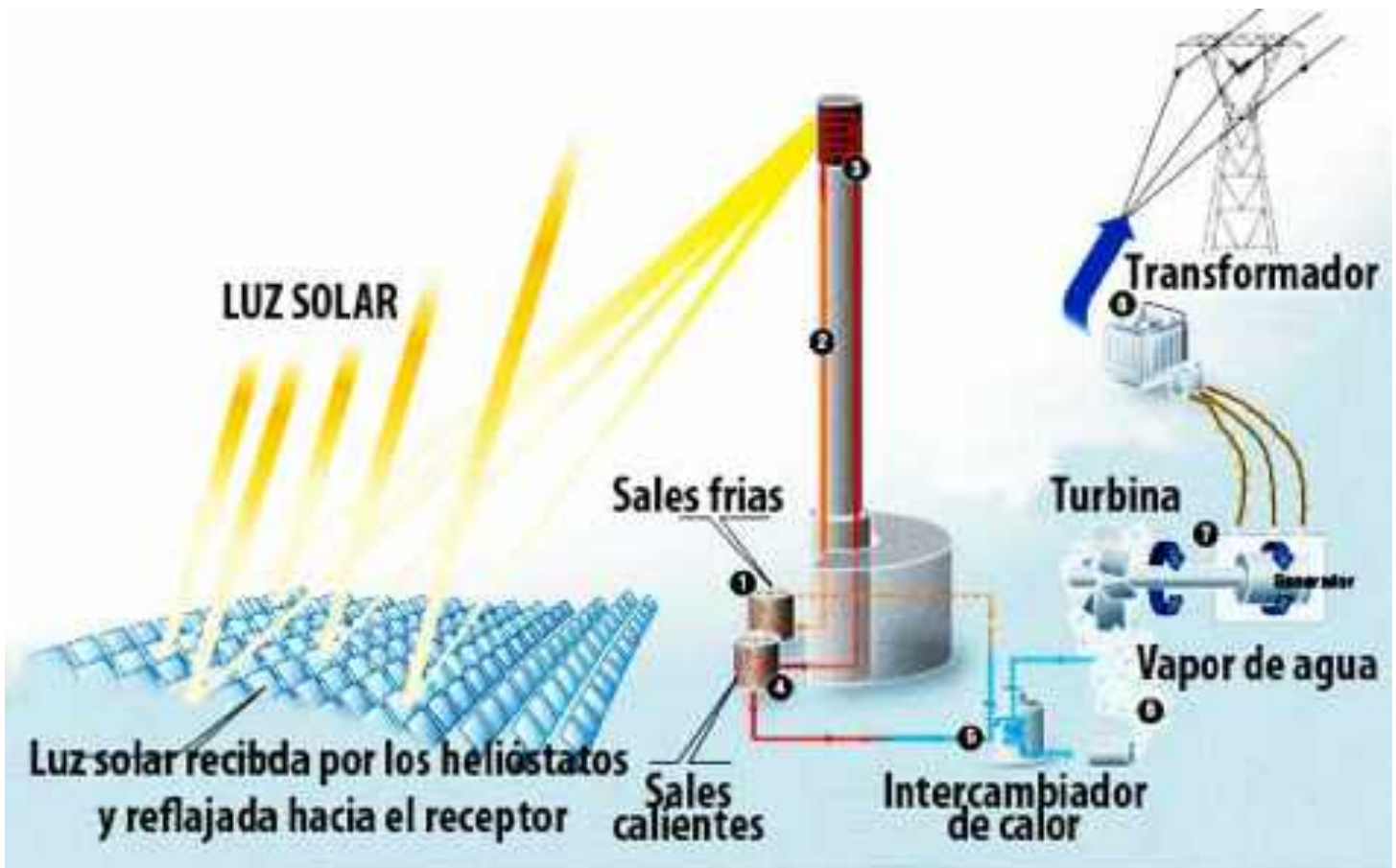
Esquema Planta Termo Solar Eléctrica con tecnología de Torre Central y sales fundidas (Fuente: www.solucionesespeciales.net ).
